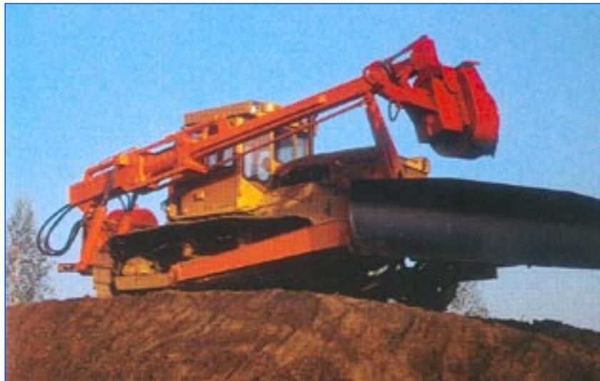
Предназначен для очистки дна каналов переменной глубины.
